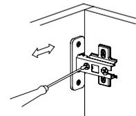
Регулировка вперед-назад. Регулируется крепежным винтом
