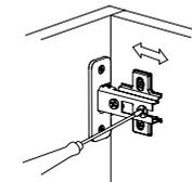
Регулировка вправо-влево. Регулируется юстировочный винт
