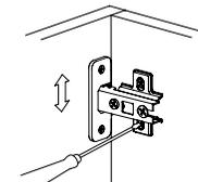
Регулировка вверх-вниз. Регулируются установочные винты
