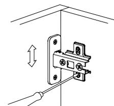
Регулировка вверх-вниз. Регулируются установочные винты
