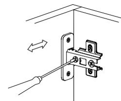
Регулировка вперед-назад. Регулируется крепежным винтом
