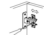
Регулировка вправо-влево. Регулируется юстировочный винт
