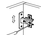
Регулировка вверх-вниз. Регулируются установочные винты
