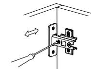
Регулировка вперед-назад. Регулируется крепежным винтом
